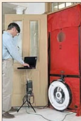
Ces phénomènes doivent impérativement être pris en compte. On utilise pour cela le test dit *Blower door* qui consiste à placer le bâtiment en dépression forcée par l'action d'un ventilateur placé en lieu et place de la porte d'entrée. L'objectif est de créer une dépression supérieure à 50 Pa (vent force 5) et de mesurer le débit des fuites d'air du bâtiment pour pouvoir ensuite en déduire les pertes thermiques tout au long de l'année.
