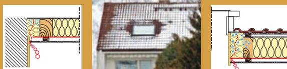
Sur cette vue de toiture, la problématique du raccordement du pare-vapeur au pignon de la maison ainsi que le raccord de celui-ci autour de la fenêtre de toit est explicite. La neige fond ou la chaleur passe, pourtant l'isolant est continu et va bien jusqu'au pignon et jusqu'au bord de la fenêtre de toit.
