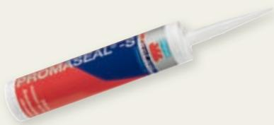
Le PROMASEAL®-S est un silicone RF monocomposant neutre ayant de bonnes caractéristiques élastiques, qui adhère sans primer sur la majorité des matériaux de construction. Grâce à son excellent comportement aux hautes températures, il obture parfaitement les ouvertures et empêche le passage des fumées froides et chaudes.
