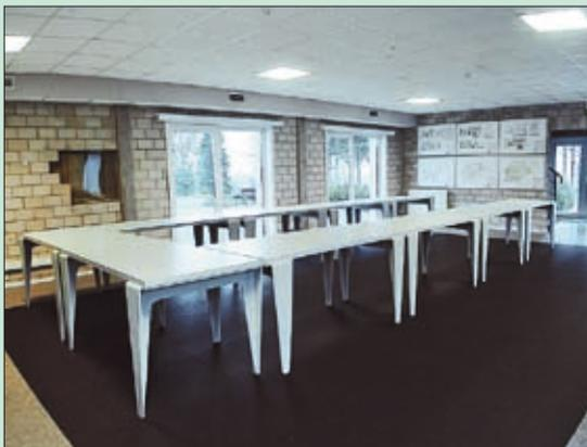
Vue de la grande salle du rez-de-chaussée, destinée aux réunions et aux conférences : la structure portante est en béton recyclé, les murs sont érigés à l'aide de blocs à base de débris de démolition concassés et de ciment blanc, le revêtement de sol comporte une couche inférieure en caoutchouc recyclé; quant au plafond, il a été réalisé au moyen de panneaux à base de laine de roche recyclée.
