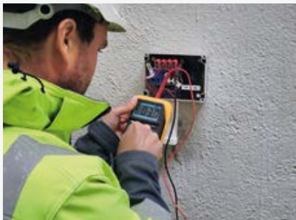
Monitoring kathodische bescherming met opofferanodes – Vandammesluis te Zeebrugge
